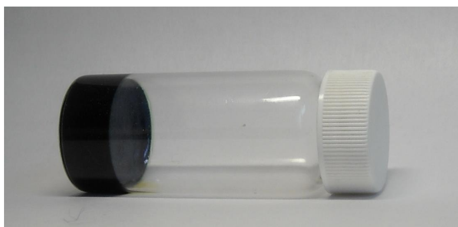
Рис. 60. Гидрогель композита ПАНИ/МУНТ, полученный ферментативным способом с использованием фитиновой кислоты.
