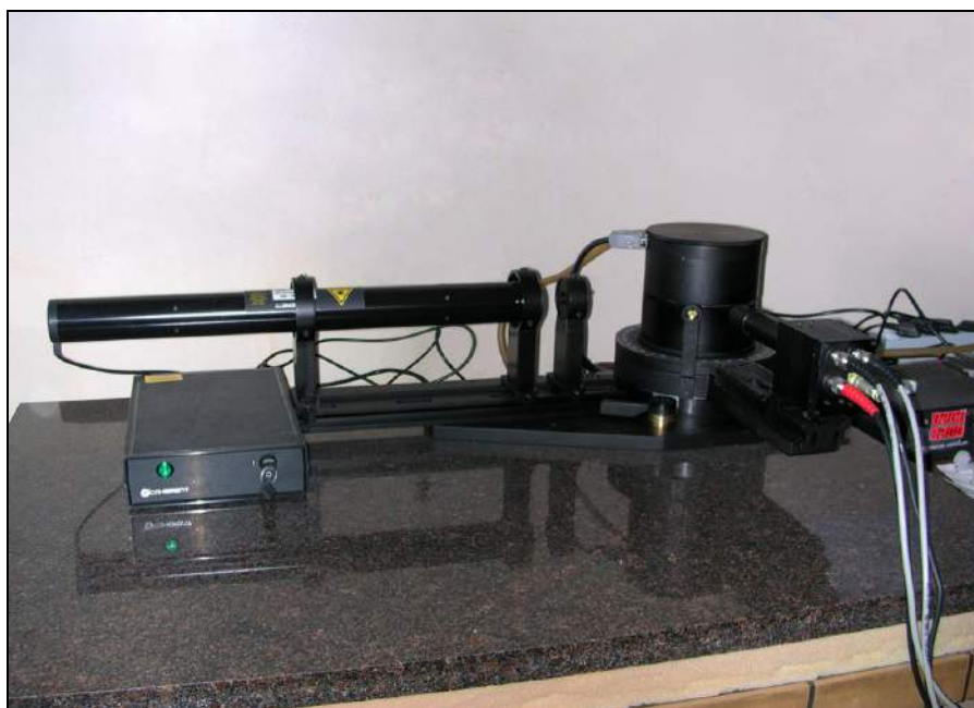
Рис. 2.2. Установка Photocor – прибор для измерения статического и динамического лазерного светорассеяния.
