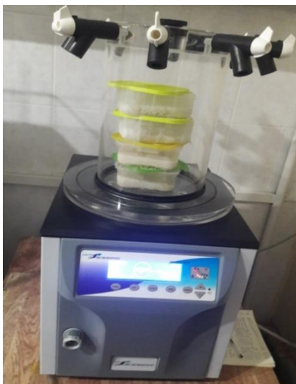
Рисунок 23 - Сушка лиофильная VirTis sp scientific sentry 2.0
